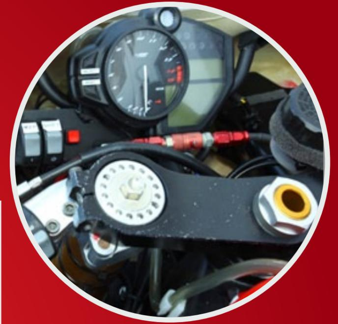
Otra exquisitez del sistema de frenado son los machones rápidos de conexión. En cada una de las pinzas, así como en la bomba, se colocan unos machones rápidos, de manera que en caso de sustitución, por caída o avería, tan sólo se tiene que girar el machón y sin pérdida de presión del sistema se sustituye en cuestión de segundos.
